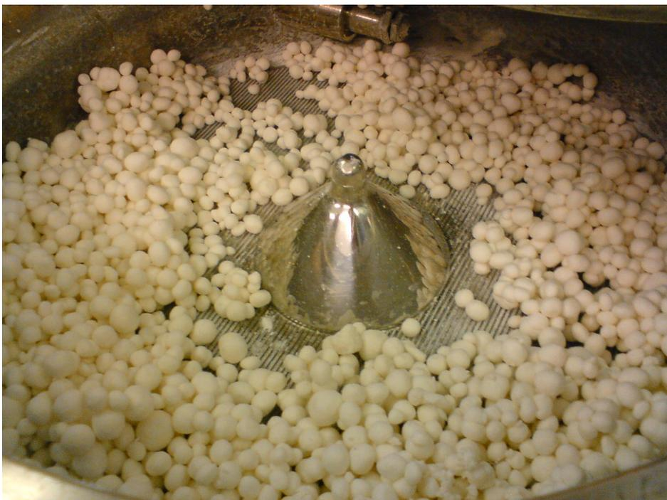
Foto 10: Technologie-Praktikum: Herstellung von Pellets
